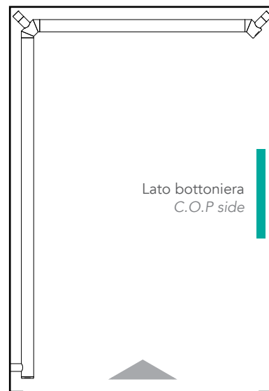
Corrimano tondo dritto in inox spazzolato o lucido fissato sui montanti d'angolo Straight brushed or shiny stainless steel round tube handrail fixed on the corners
